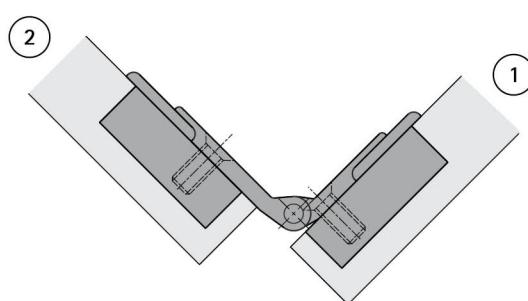
1. Регулювання фуги: безступінчасто від 0 до + 4 мм
