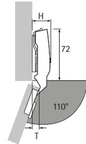
Высота петли H / выступ двери T для дистанции D = 0 мм и расстояния до чашки C = 3 мм
