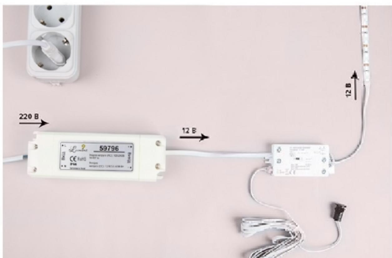
Вставляємо вилку в розетку, і... запрацювало! При стандартних налаштуваннях вимикач працює в режимі на відчинення дверей, тому стрічка одразу засяє, проте при появі перепони в зоні дії вимикача світло згасне.
