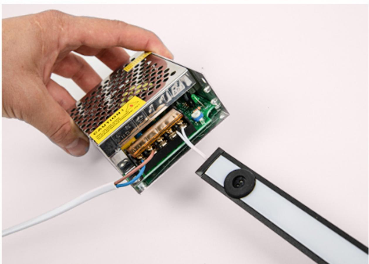
Далі оголений кінець дроту сенсорного вимикача з позначенням «IN+» закріплюємо в затискачі блока живлення «V+», а «IN-», відповідно, в «V-».
