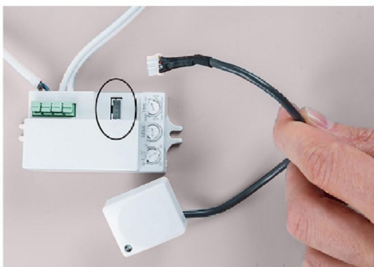
А тепер підключаємо сенсорний елемент до керуючого блоку сенсорного вимикача. Зверніть увагу на корпус вимикача, там ви побачите три круглі регулятори, за допомогою яких можна вибрати потрібний режим роботи вимикача.
