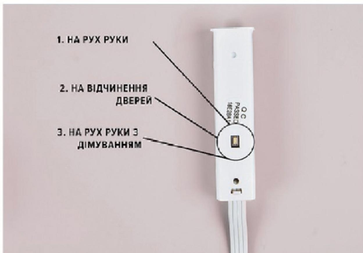
Коротким натисканням на кнопку перемикаються режими на рух руки та на відчинення дверей, а для вибору режиму роботи на рух руки з дімуванням потрібно затримати натискання на 5 с. Після цього вимикач переїде у вибраний режим, про що повідомить кількаразове мигання світильника.
