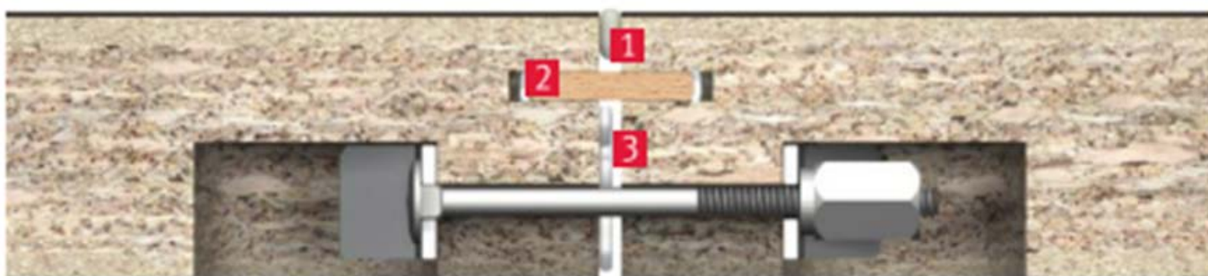
Мал. 14, де: 1 – герметик; 2 – шкант; 3 – клей
