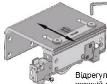
Відрегулюйте верхній ролик для передніх дверей
