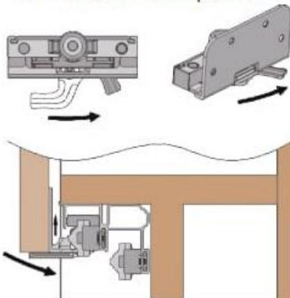
Поверніть важіль нижнього ролика проти годинникової стрілки. Таким чином нижній ролик підніметься в нижню рейку.
