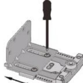
Відрегулюйте нижній ролик для передніх дверей
