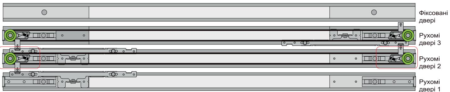
Зсуньте з'єднувальну частину в положення значка, потім закріпіть нержавіючим тросом.
