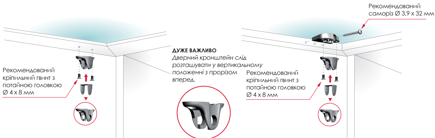
ВСТАНОВЛЕННЯ НА ШИРОКІ АЛЮМІНІЄВІ РАМКОВІ ДВЕРІ
