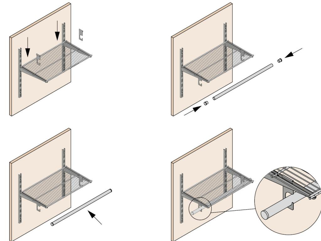
3. Монтаж труби 25 мм до нижньої частини полиці з ДСП за допомогою кріплення R-50 або труби овальної (79789) та тримачів (51242, 51243).
