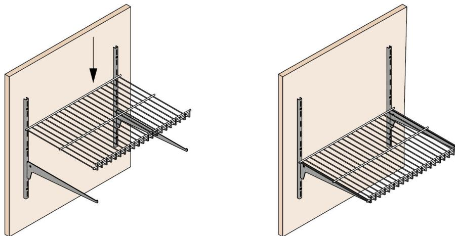
При використанні кронштейна довжиною 350 мм взуттєва полиця розміщується під кутом до підлоги:
