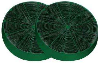
Високоекспективний вугільний фільтр багаторазового використання виготовляється з двох шарів сітчастого пінополіуретану, покритих гранульованим активованим вугіллям. Ефективність очищення запахів - 80%. Після 3-4 місяців використання може бути відновлений в посудомийній машині. Після 10 циклів очищення підлягає заміні.
