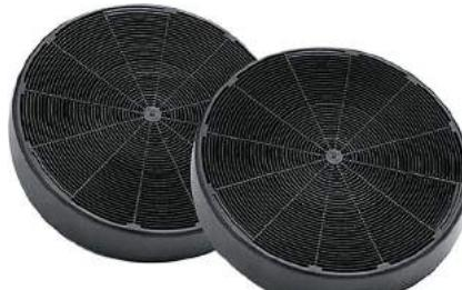
Високоекспективний вугільний фільтр виготовляється з карбонового бісеру, покритого поліуретаном. Ефективність очищення запахів - 82%. Після 6 місяців використання підлягає заміні.
