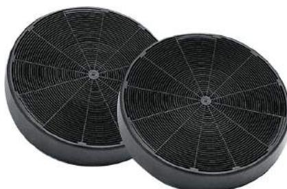
Стандартний вугільний фільтр виготовлений з екструдованих вуглецевих циліндрів, що активуються від контакту з парою. Ефективність очищення запахів - 50-60%. Після 2-3 місяців використання підлягає заміні.
