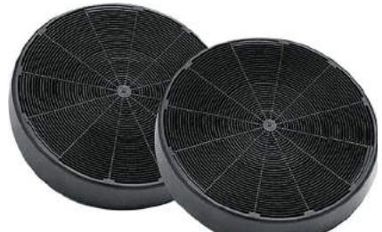
Вугільний фільтр багаторазового використання виготовлений з одного шару сітчастого пінополіуретану, покритого гранульованим активованим вугіллям. Ефективність очищення запахів - 66%. Після 3-4 місяців використання може бути відновлений в посудомийній машині. Після 8 циклів очищення підлягає заміні.
