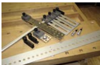
Сверильный кондуктор Assura с различными шаблонами. Практичная модульная система для широкого применения
