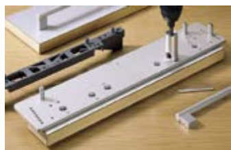
Минимальный износ сверла, так как режущие кромки не соприкасаются с кондуктором.
