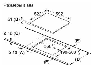
A: Минимальное расстояние от выреза для варочной панели до стены.
